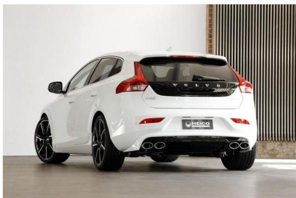
Um die Doppelrohr-Abgasanlage einwandfrei montieren zu können benötigen Sie bei Fahrzeugen mit nur einem serienmäßigen Endrohr die originale Volvo Heckschürze des T5.
