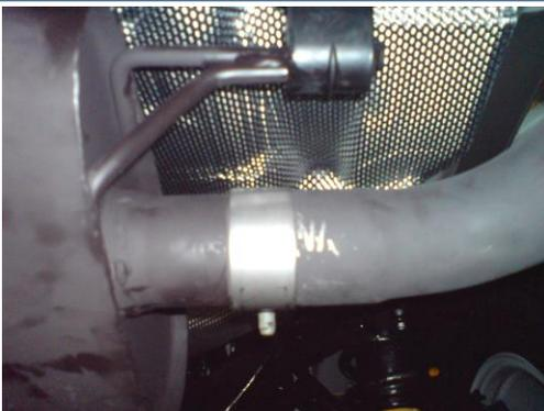
Hängen Sie den Endschalldämpfer in die Gummilager ein. Montieren Sie anschließend die Rohrbögen mit den Endrohren und der Schellen. Richten Sie die Endrohre an der Heckschürze aus und ziehen Sie alle Schellen anschließend fest. **Ziehen Sie die Schelle zum vorderen Rohr der originalen Abgasanlage als letzte fest. Zuvor bitte vergewissern dass die Endrohre zur Heckschürze ausgerichtet sind.**
