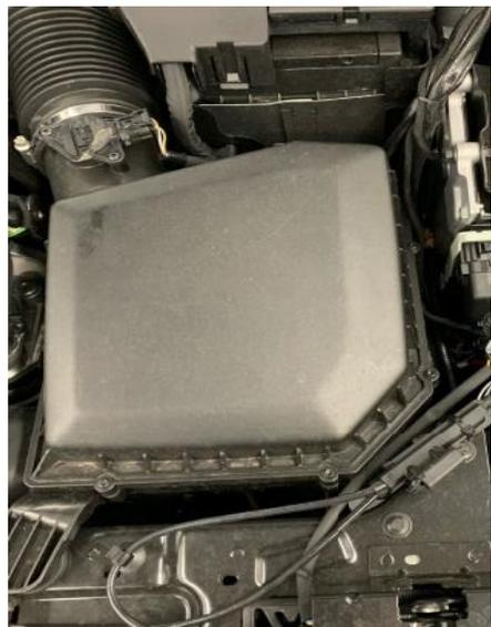
Den oberen Stecker des Motorsteuergerätes lösen und die Abdeckung entfernen
