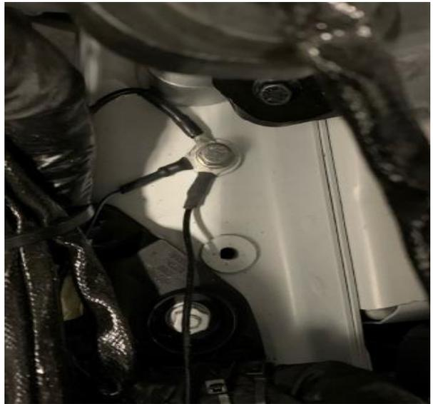
Kabel verlegen und mit Kabelbinder Sichern. Das Steuergerät an einem geeigneten Ort befestigen (z.B. Batteriekasten).
