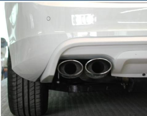
Nun kann die Abgasanlage verbaut – und die Endrohre am Heckdiffusor ausgerichtet werden. Zu Details siehe die Montageanleitung der Abgasanlage.
