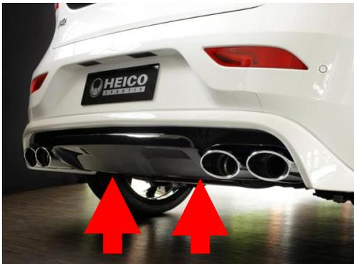
Anschließend ist der, zuvor lackierte, HEICO SPORTIV Heckdiffusor in die originale Heckschürze einzurasten. Vergewissern Sie sich, dass alle Klipse richtig einrasten sowie, dass die PDC Sensoren montiert sind und deren Kabelbaum sicher befestigt wurde. Abschließend werden die beiden unteren Kunststoffdübel, welche in Schritt 1 entfernt wurden, wieder befestigt.
