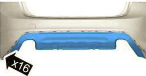
Nun sind die 16 Klipse des Heckschürzeneinsatzes zu entriegeln. Verwenden Sie hierzu einen Kunststoff-Keil um die Klipse aus den Verankerungen zu lösen. Anschließend können Sie den Heckschürzeneinsatz vorsichtig heraus ziehen und, falls vorhanden, die Stecker und den Kabelbaum der PDC Sensoren entfernen. Entfernen Sie anschließend auch die PDC Sensoren und übergeben diese ggf. der Lackiererei.
