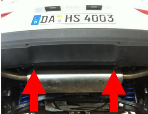
Heben Sie das Fahrzeug mit einer Hebebühne auf Arbeitshöhe an. Entfernen Sie die beiden unteren Kunststoffdübel am Heckschürzeneinsatz unten.
