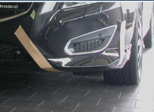
Fixieren Sie die Frontspoiler mit Klebeband. Gegebenenfalls heraustretenden Klebstoff können Sie mit einem in Silikonentferner getränktem Tuch entfernen. Nach 24h ist der Klebstoff durch gehärtet. Stellen Sie das Fahrzeug während dem Trockenvorgang an einer trockenen und warmen Stelle unter.
