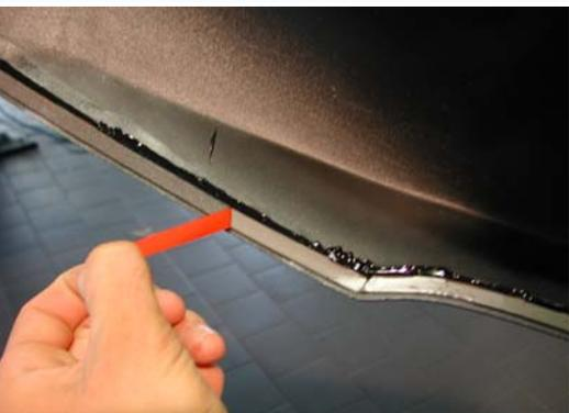
Entfernen Sie nun den Schutzfilm der Klebestreifen vollständig und montieren Sie die Frontspoiler. Achten Sie auf die richtige Position, bevor Sie die Frontspoiler vollständig andrücken. Verschrauben Sie die Frontspoiler leicht mit der Unterseite an die Frontschürze. Erst nachdem der Kleber vollständig ausgehärtet hat (24h) sind die Schrauben fest zu ziehen.
