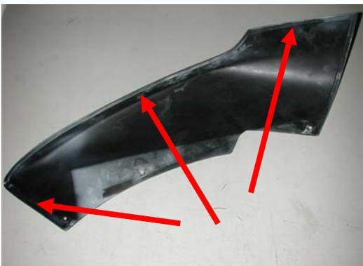
Nun sind die inneren Klebeflächen der Frontspoilerhälften anzuschleifen und mit dem mitgelieferten ELCH PRO- Reiniger zu reinigen. Tragen Sie den mitgelieferten Klebstoff auf die Innenseite der Frontspoiler entlang der Klebefläche (Vertiefung) auf. Die Kleberaube sollte etwa 0,5 cm breit und hoch sein.
