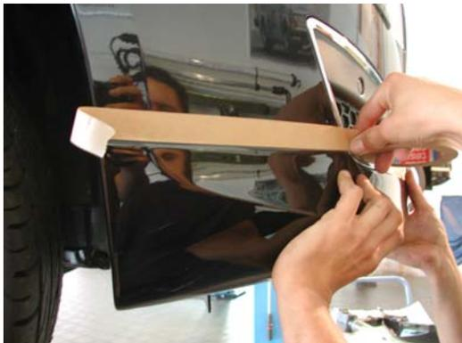
Reinigen Sie die Klebefläche der Frontschürze mit dem mitgelieferten ELCH PRO- Reiniger. Schützen Sie angrenzende Flächen mit Klebeband!
