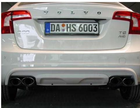
Anschließend ist der, zuvor lackierte, HEICO SPORTIV Heckdiffusor in die originale Heckschürze zu verklipsen. Vergewissern Sie sich, dass alle Klipse richtig einrasten und die PDC Sensoren montiert sind. Abschließend werden die beiden unteren Schrauben oder Klipse, welche in Schritt 1 entfernt wurden, wieder befestigt.
