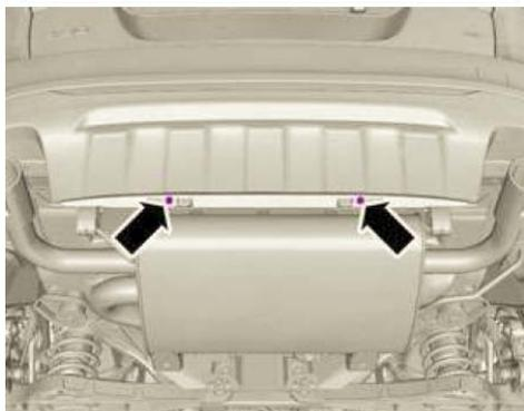
Heben Sie das Fahrzeug mit einer Hebebühne auf Arbeitshöhe an. Entfernen Sie die beiden unteren Schrauben am Heckschürzeneinsatz unten. Bohren Sie die Klammer- Muttern der unteren Befestigung mit einem 7,0 mm Bohrer auf, falls Sie die mitgelieferten Klipse verwenden möchten.
