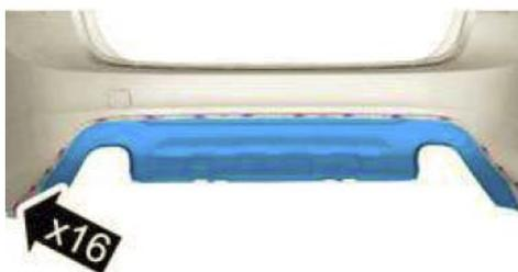
Nun sind die 16 Klipse des Heckschürzeneinsatzes zu entriegeln. Verwenden Sie hierzu einen Kunststoff- Keil um die Klipse aus den Verankerungen zu lösen. Anschließend können Sie den Heckschürzeneinsatz vorsichtig heraus ziehen und, falls vorhanden, die Stecker der PDC Sensoren entfernen. Entfernen Sie anschließend auch die PDC Sensoren und übergeben diese ggf. der Lackiererei.
