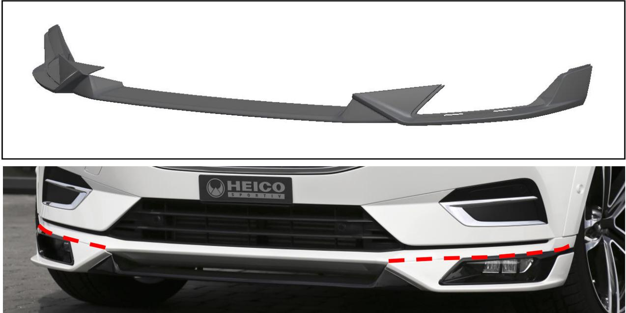
Halten Sie die Frontspoiler an die Frontschürze (ohne die Schutzfolie des Klebebandes zu entfernen) und markieren Sie das Ende der Bauteile mit Klebeband. Anschließend entnehmen Sie die Frontspoiler wieder und behandeln die bereits gereinigte Klebefläche mit Primertüchern oder Isoporpanol an den Klebestellen. Alternativ zu der Methode mit dem Klebeband, kann auch der Frontspoiler mit den beiden mittleren Schrauben fixiert - und anschließend verklebt werden.
