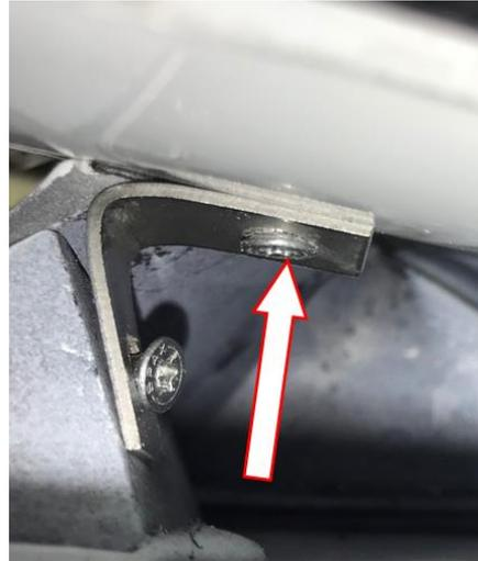
Zum Abschluss werden die beiden kleinen Edelstahl-Senkkopfschrauben durch die Senkbohrung am Frontspoiler geschraubt. Bohren Sie das Loch nicht vor, sondern schrauben die Schraube direkt durch.
