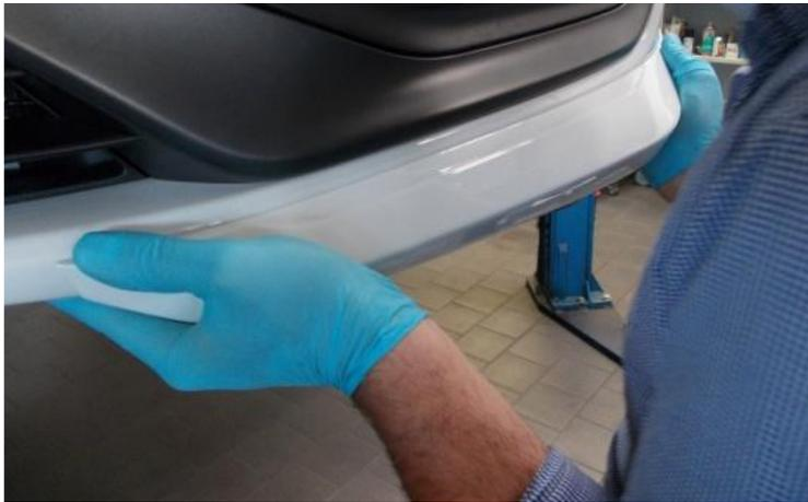
Nun sind die beiden Einsatzteile zu montieren. Entfernen Sie hierzu erneut nur ein Stück des Schutzfilms vom Klebeband und biegen sie dieses nach oben. Achten Sie beim Einführen der Teile darauf, dass die beiden Nasen in den dafür vorgesehenen Öffnungen eingeschoben werden.
