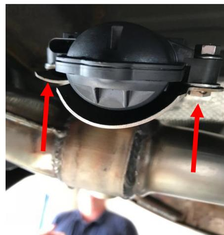
Bei Fahrzeugen mit Abgasstauklappe ist darauf zu achten das diese Spannungsfrei montiert ist und die mitgelieferten Unterlegscheiben unter den Stellmotor montiert werden
