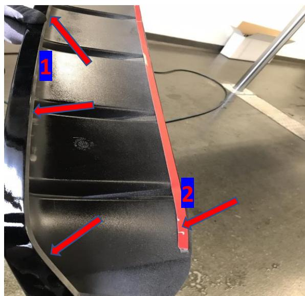
Den Heckdiffusor auf der unteren Kante der Serien-Heckschürze auflegen und mittig ausrichten. Darauf achten das der kleine Spalt zwischen Serienoberteil und Heckdiffusor gleichmässig ist und der Heckdiffusor richtig auf der Unterkante liegt!
