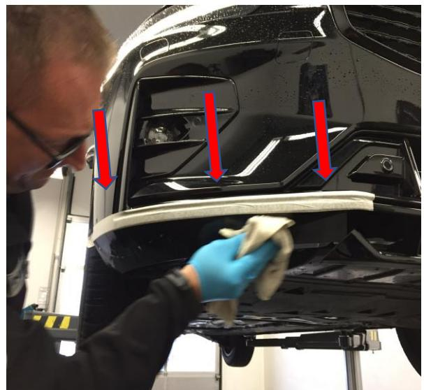
Beim verkleben von der Mitte aus beginnen um dem exaktem Verlauf der Frontschürze folgen zu können. Die Anbindung zum Mittelteil und zur Radhauskante muss gewährleistet sein.
