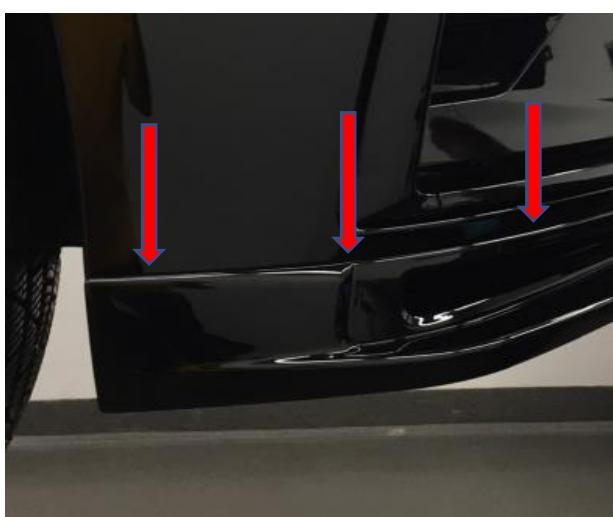
Die Frontflaps, mit den mitgelieferten Schrauben/Hülsen, von unten an der Frontschürze befestigen.
