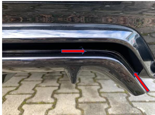
Nach der Trocknungsphase die beiden Sicherungsschrauben für den Heckdiffusor anbringen.
