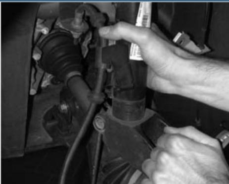
Durch herunterdrücken des Radträgers legen Sie den Stossdämpfer frei. Falls Ihr Fahrzeug älter ist verwenden Sie Rostlöser um die Demontage zu vereinfachen.
