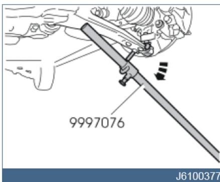
Drücken Sie den Anschlagpuffer in die Staubmanschette.
