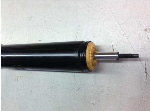
Schieben Sie nun die **originale** Staubkappe mit dem eingeschobenen Anschlagpuffer auf die Kolbenstange des HEICO SPORTIV Hinterachsdämpfers. Nun kann der Hinterachsstoßdämpfer verbaut werden.
