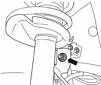
Entfernen Sie nun die Bremsleitung aus ihrem Halter und trennen Sie den Stecker vom ABS- Sensor. Danach lösen Sie die Schraube der Federbeinaufnahme am Radträger.
