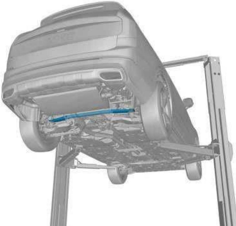
**15. Den Steckverbinder lösen / Disconnect the marked connector**
