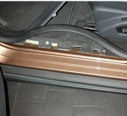
Legen Sie die Schutzformverkleidung bei Seite und lösen Sie den Türdichtgummi im unteren Bereich indem Sie diesen nach oben weg ziehen. Entfetten Sie die Schweller gründlich. Montieren Sie nun die Einstiegsleisten mittig auf den Schwellern. Achten Sie dabei auf Links und Rechts. Ziehen Sie zuvor die Schutzfolie vom Klebeband unter den Einstiegsleisten ab.
