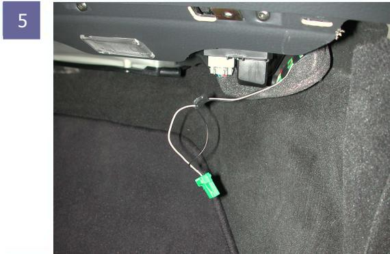
5 Löten Sie nun die Kabel der beleuchteten Einstiegsleisten an die Kabel der Fußraumbeleuchtung an. Isolieren Sie die Verbindungsstelle ausreichend. Anschließend montieren Sie wie unter Abschnitt 2 beschrieben die Schutzformverkleidung sowie den Türdichtgummi.
