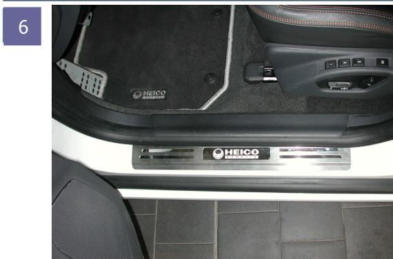
6 Entfernen Sie nun die Schutzfolien der Acrylglasflächen auf den Einstiegsleisten. Anschließend führen Sie einen Funktionstest durch. Die beleuchteten Einstiegsleisten müssen gemeinsam mit der Fußraumbeleuchtung leuchten und erlöschen.
