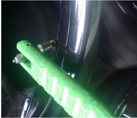
Montieren Sie mit einem geeigneten Werkzeug die mitgelieferten Ventile. Vermeiden Sie eine Beschädigung der Felgen durch falsches Werkzeug! Die Felge mit der Sichtseite nach oben auf die Montiermaschine spannen!!!!
