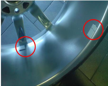
Verwenden Sie ausschließlich Klebegewichte! Montieren Sie die Gewichte an den gezeigten Punkten auf der Innenseite der Felge. Stellen Sie ihr Wuchtgerät auf diese Positionen ein.
