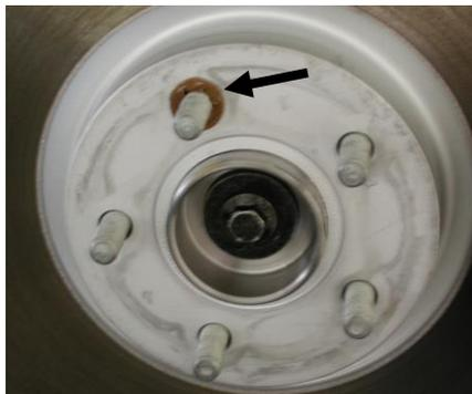
Bei einigen Fahrzeugen sind die Bremsscheiben zusätzlich mit einer Klemmsicherung gesichert.
