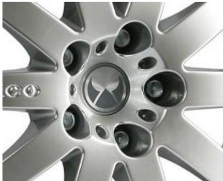
Abschließend sind die Nabendeckel zu montieren. Aus optischen Gründen empfehlen wir diese zum HEICO- Schriftzug auszurichten.
