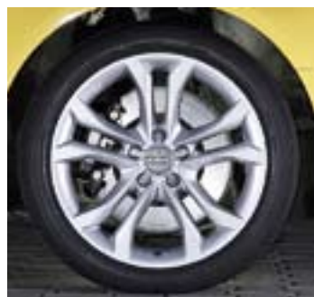
An der Vorderachse messen die Bremsscheiben 345 Millimeter
