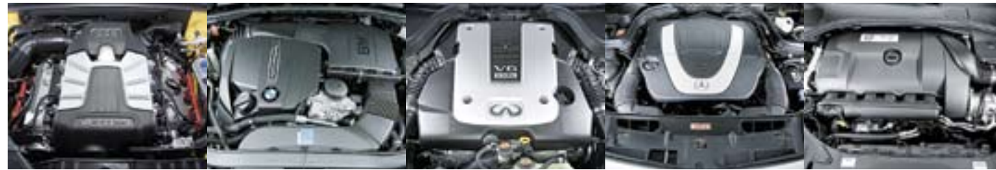
Der Audi-V6 bietet den bulligsten Antritt. BMW kontert mit einem feinen Turbotriebwerk, das vor allem mit seiner Drehfreude begeistert. Der V6-Sauger von Infiniti bevorzugt genauso wie das Mercedes-Aggregat den mittleren Drehzahlbereich. Beim Volvo generiert ein Turbo kultivierte Kraft in allen Lagen
