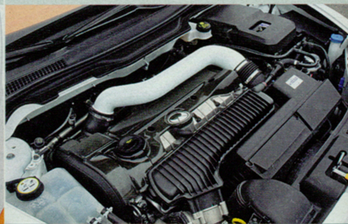
Saubere Arbeit: Unter der perfekt angepassten Kohlenfaser-Blende sitzt der Fünfzylinder-Turbo mit 260 PS
