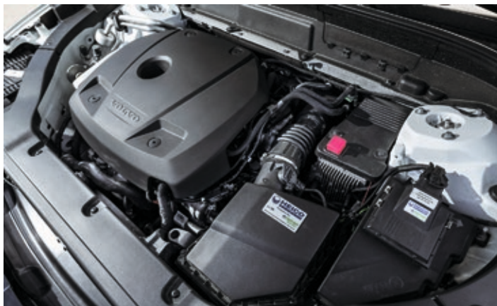
Das Zusatzsteuergerät von Heico entlockt dem 2,0-Liter-Turbo-Kompressor 340 statt 310 PS, das Drehmoment steigt von 400 auf 440 Nm
