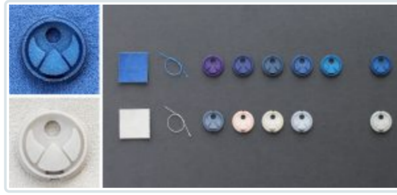
Die einzelnen Farbentwicklungsstufen bis hin zum exakt reproduzierbaren Farbergebnis. (Bildquelle: Kegelmann Technik) Q
