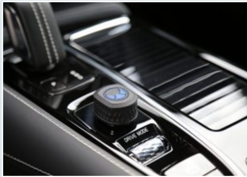
Das Startknopf-Cover wird über das Serienteil gesteckt und arretiert automatisch. (Bildquelle: Heico Sportiv) Q
